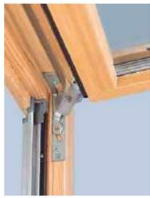
Außerdem wird dadurch die innere Überschlagsdichtung nicht unterbrochen, was für eine höhere Dichtigkeit und besseren Schallschutz sorgt. Auf Wunsch liefern wir Beschlagsausführungen bis zur Widerstandsklasse 2.
