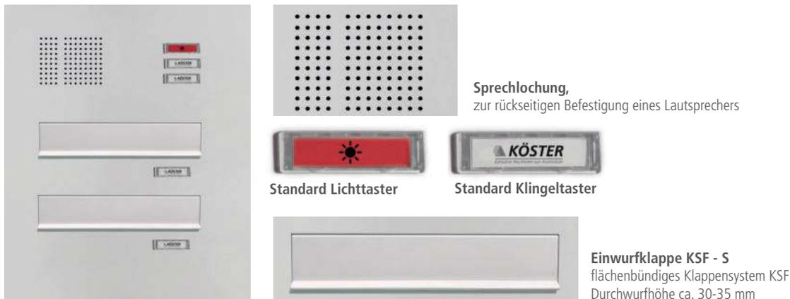
Thermisch getrennte Briefkastenanlage im geschlossenen Sandwichpaneel (36 mm stark) mit aufgesetzten Klingeltastern, gestanztem Sprechsieb sowie eingelassenen Briefeinwürfen.
