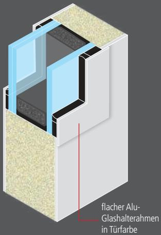
Alle Türen verfügen über optimiertes Wärmeschutz- und Verbundsicherheitsglas mit thermisch verbessertem Randverbund (warme Kante).
